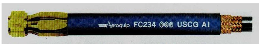
**構造:** AQPエラストマーチューブ、真鍮メッキを施した鋼鉄ワイヤー補強層、サイズにより必要なブレード付き耐火絶縁材およびブルーAQPエラストマーカバー。
