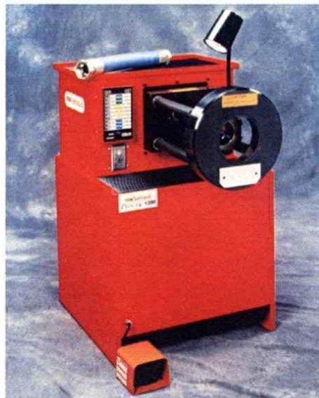
内径2インチ迄のサイズの油圧ホース・アセンブリを加締め出来るProCrimp 1390・クリンプ・マシンは、エアロクイップが米州(北中南米)で製造する全てのクリンプ加締めフィッティングスタイルを収納する能力と力を有しています。ProCrimp 1380と同様に、ProCrimp 1390は、プログラマブルな電子式制御の使用によって、正確で繰り返し可能かつ信頼できる性能を提供するように設計されてます。
